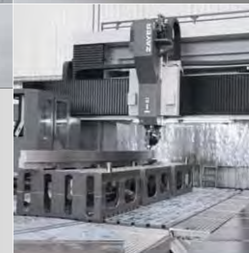
Płyta montażowa w maszynie Gantry
