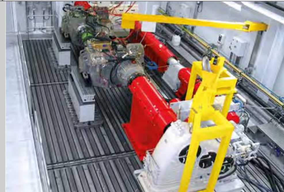
Stanowisko testowe przekładni okrętowych 15.000 x 8.000 mm
