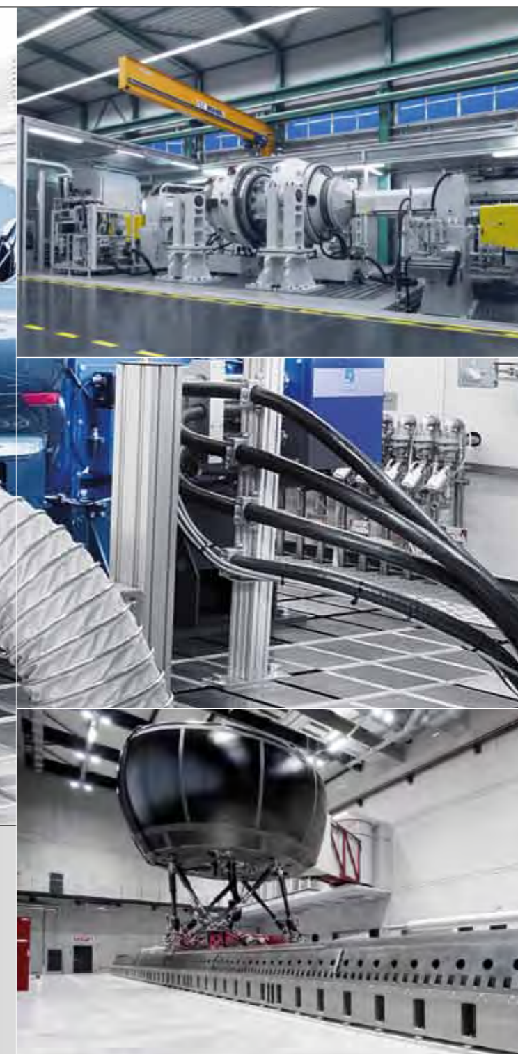
Symulator jazdy w miejscowości Sindelfingen Stanowisko robota równoległego Hexapod na poduszkach powietrznych i łożu betonowym o długości 31 000 mm
