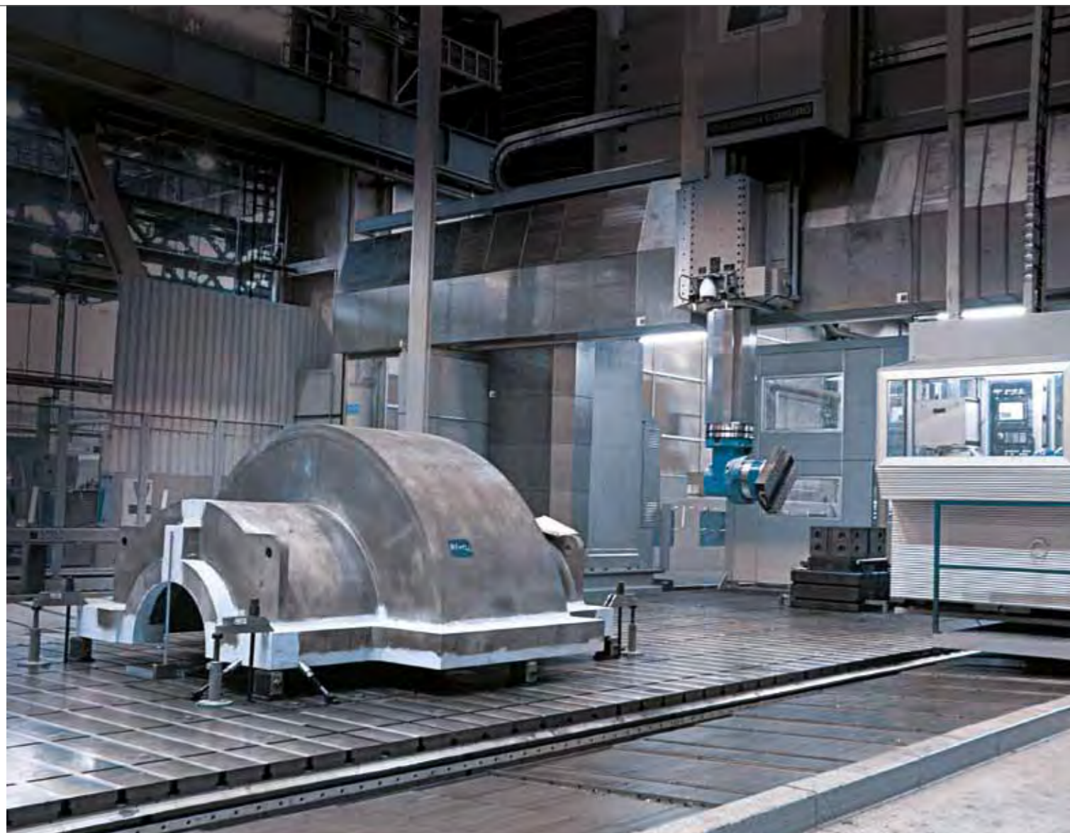
Centrum obróbki wielkogabarytowej w systemie Gantry z zastosowaniem płyty montażowej STOLLE 32.000 x 6.000 mm
