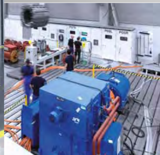
Stanowisko testowe generatora
