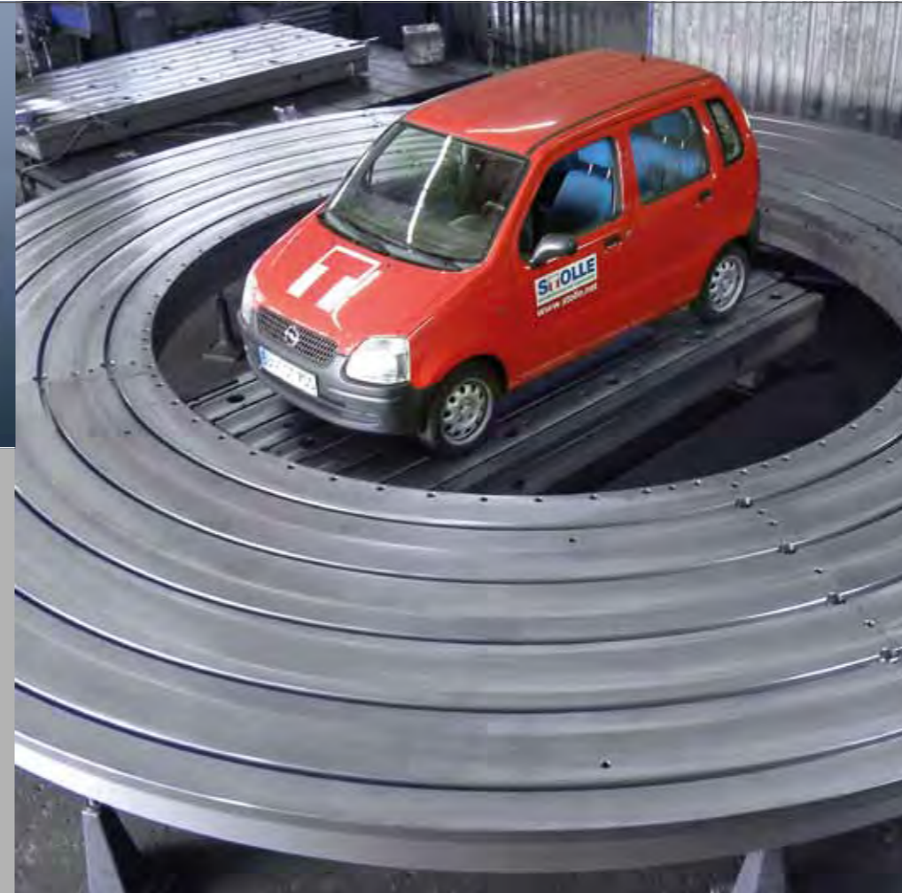
Stół obrotowy o średnicy 10 000 mm do obróbki śrub okrętowych
